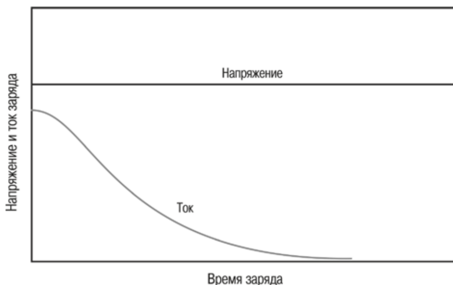
Рис. 5. График выравнивающего заряда
